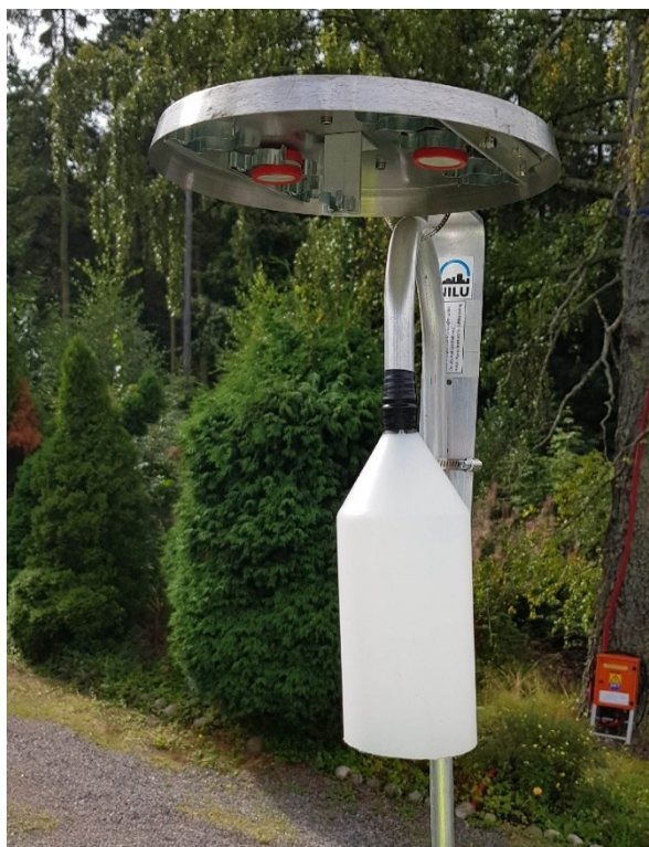
Figur 5: Passive prøvetakere i stativ som gir værbeskyttelse. Her vises prøvetakeren som er samlokalisert med målestasjonen i Konsul Wilds vei. Bildet viser 2 parallelle prøvetakere, som ble brukt i 2019. I 2024 var det én prøvetaker per målepunkt. Merk at den er montert rett ovenfor inntaket til SO 2 -monitoren. Foto: Even Kristian Teigland.
