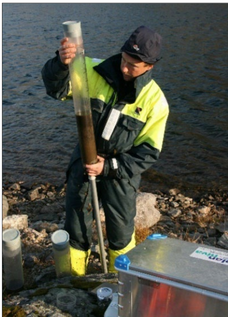
Figur 9. Innsjøsedimenter ble samlet inn med en gravitasjons corer (kjerneprøvetaker). Foto: Akvaplan-niva.
