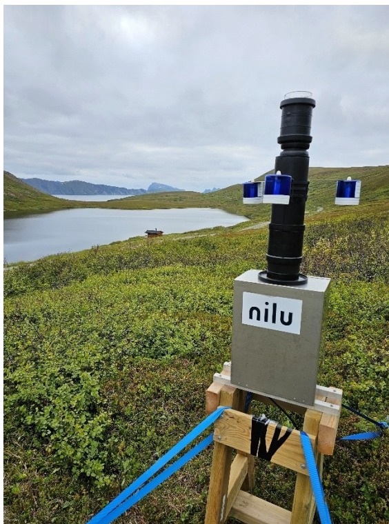
Figur 13: Passive luftprøvetakere for Hg (MerPAS). Totalt tre luftprøvetakere er montert ved inntaksrøret til nedbørprøvetakeren, derav to prøver og én blindprøve. Foto: Sébastien Oftedal Barrault, NILU.
