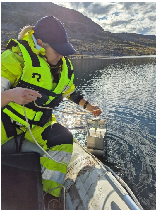
Figur 16: Sedimentprøvetaking fra båt. Prøvene tas fra det dypeste punktet i innsjøen ved bruk av Ekmansgrabb.
