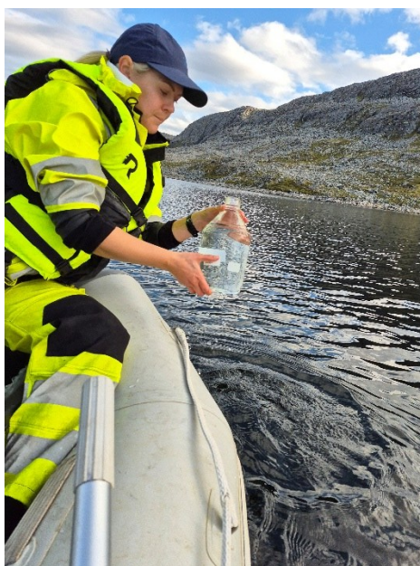
Figur 15: Vannprøvetaking fra båt. Merk at prøvene tas i baugen fra båt i sakte bevegelse fremover. Dette for å unngå kontaminering fra båt eller personell.
