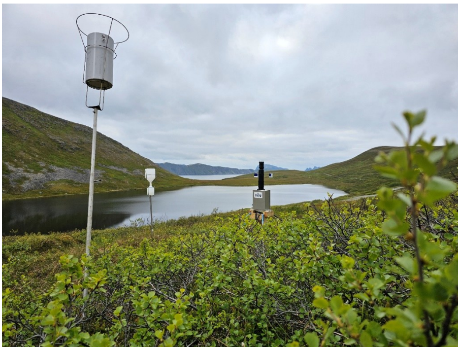
Figur 14: Nedbørprøvetakere ved NVF5 (Gamvikvannet på Sørøya). Fra høyre til venstre: nedbørprøvetaker for Hg (skjøre glasselementer beskyttes av metallskapet og det svarte røret; luftprøvetakere for Hg er montert ved inntaksrøret), nedbørprøvetaker for Pb (plasttrakt med plastflaske), nedbørprøvetaker for PAH (aluminiumssamler). Foto: Sébastien Oftedal Barrault, NILU.
