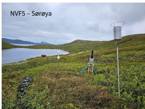
Figur 5: Prøvetakingsstasjoner for luft, nedbør, vegetasjon og jord. NVF1 Hammerfest: Langvannet synes i bakgrunnen, NVF2 Seiland: Russelvatn ligger ca. 11 km lenger sør, NVF3 Forsøl: Storvikvannet ligger ca. 7,5 km mot sørøst, NVF4 Stangnes: Nuorejávri ligger ca. 5,5 km mot øst-nordøst, NVF5 Sørøya: Gamvikvannet synes i bakgrunnen. Legg også merke til barduneringen av Hg-prøvetakerne. Det kan være værhardt på Finnmarkskysten selv om sommeren. Foto: Sébastien Oftedal Barrault (NILU)
